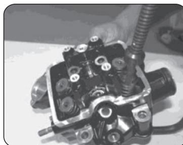
► **Adaptador para el Compresor del Resorte de Válvulas**
