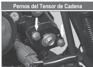
Torque de Ajuste: 1.0 ~ 1.2 kg-m
