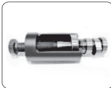
► **Extractor del Rodamiento Pequeño del Eje de Levas**
