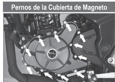
Torque de Ajuste: 1.0 ~ 1.2 kg-m
