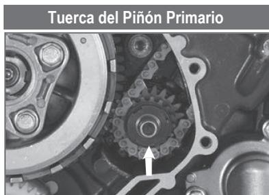
Torque de Ajuste: 5.9 ~ 6.1 kg-m
