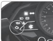
9 - Indicador de Mal Funcionamiento del Motor
