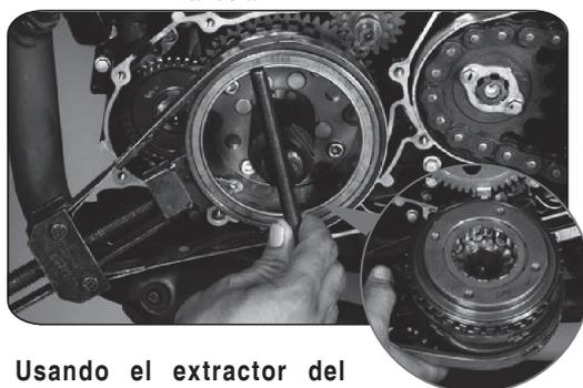
Usando el extractor del volante, tire del rotor.
