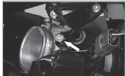
Torque de Ajuste: 0.8 ~ 1.0 kg-m
