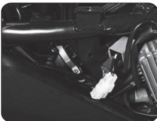
Afloje la abrazadera del lado del filtro de aire
