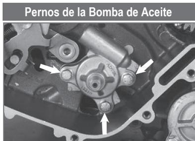
Torque de Ajuste: 1.0 ~ 1.2 kg-m
