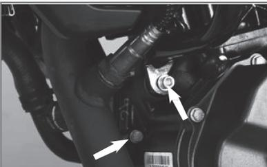
Torque de Ajuste: 2.5 ~ 3.0 kg-m
