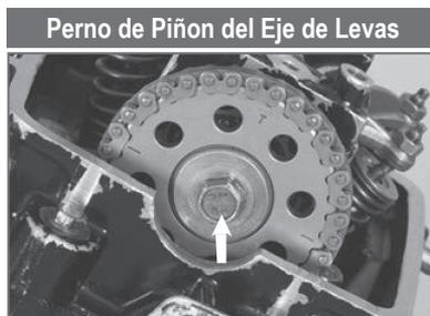
Torque de Ajuste: 2.5 kg-m
