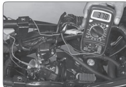
Revisión del Voltaje de Salida
