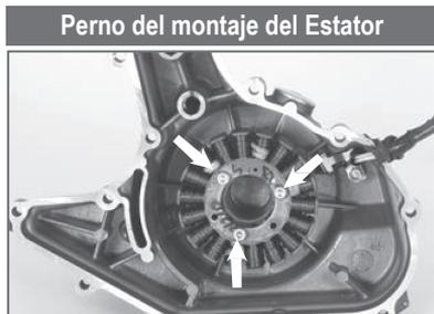
Torque de Ajuste: 0.7 ~ 0.8 kg-m
