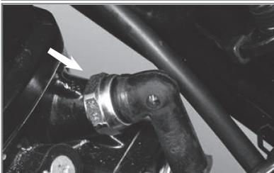
Torque de Ajuste: 1.1 ~ 1.5 kg-m
