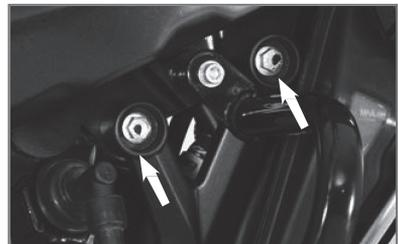
Torque de Ajuste: 2.5 ~ 2.7 kg-m
