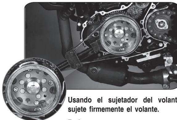
Usando el sujetador del volante, sujete firmemente el volante.
