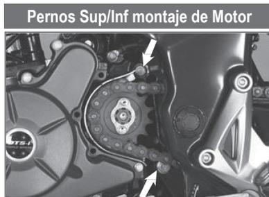
Torque de Ajuste: 2.5 ~ 3.0 kg-m
