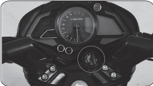
Coloque el suiche de encendido en la posición OFF
