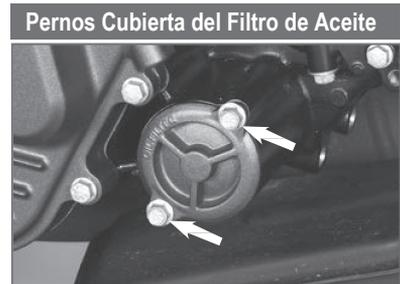
Torque de Ajuste: 1.0 ~ 1.2 kg-m
