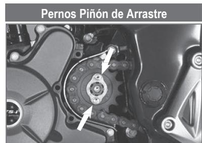
Torque de Ajuste: 1.0 ~ 1.2 kg-m
