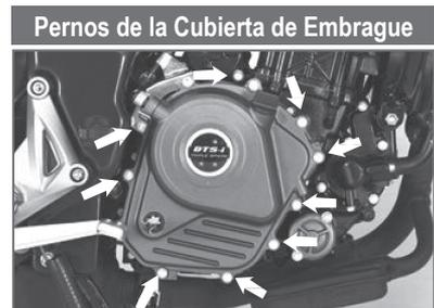
Torque de Ajuste: 1.0 ~ 1.2 kg-m
