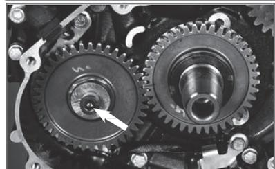
Torque de Ajuste: 2.2 ~ 2.5 kg-m
