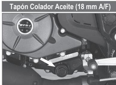
Torque de Ajuste: 0.8 ~ 1.0 kg-m
