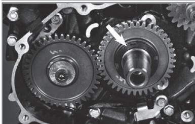
Torque de Ajuste: 5.9 ~ 6.0 kg-m
