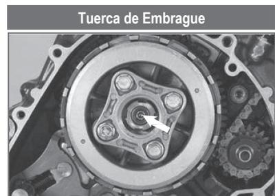
Torque de Ajuste: 7.0 ~ 7.1 kg-m
