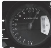
**Limitador de RPM del motor:** Un LED ámbar comienza a parpadear cuando el motor alcanza las 9500 RPM, alertando al conductor que está cruzando la zona segura. (Sin embargo, el motor se apagará al alcanzar los 10500)
