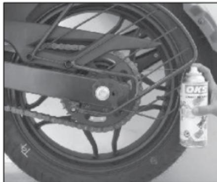
Método para lubricar cadena con O´ring
