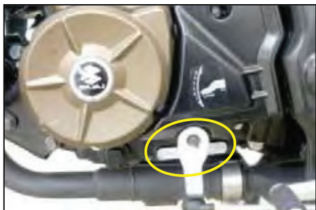
◀ Ubicación numero Motor Lado Izquierdo cigueñal cerca de la palanca
