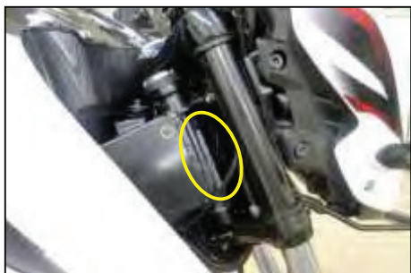
◀ Ubicación numero chasis (NS150) Lado derecho Chasis de direccion (Alfa-numerico - 17 digitos)
