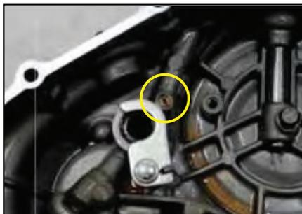
**LIMPIEZA INYECTOR CUBIERTA DEL CLUTCH**
