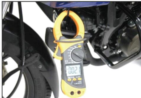
**Equipo de Prueba y Medidas: Medidor de Pinza**
