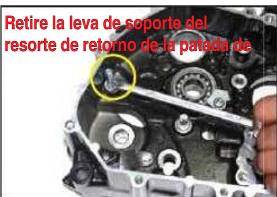
**Retire la leva de soporte del resorte de retorno de la patada de arranque**
