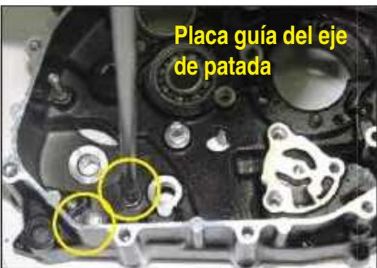
**Placa guía del eje de patada**
