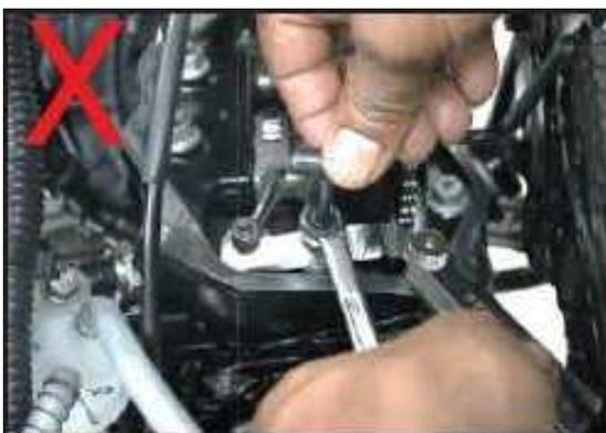
**Nota:** No ajuste la luz de las válvulas de admisión/escape simultáneamente.
