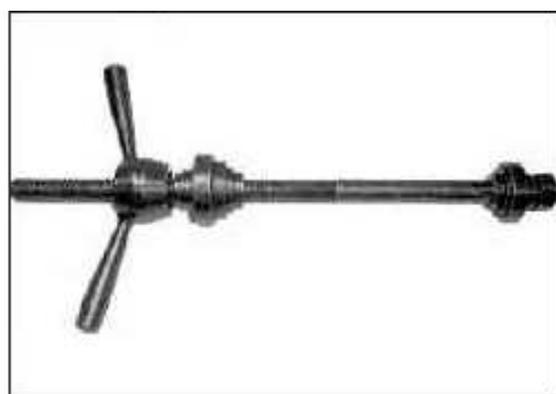
**Instalador de Rodamiento Superior e Inferior del Chasis**
