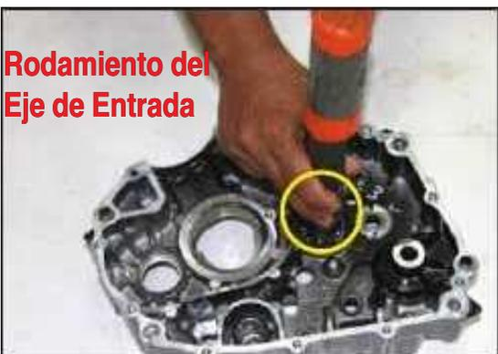
**Rodamiento del Eje de Entrada**
