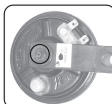
Nunca ajuste la tuerca en el lado de la tapa del pito (atrás) ya que puede resultar en malfuncionamiento del pito o falla.
