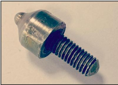
**Herramienta de ajuste del freno combinado**
