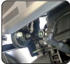
Asegure que el pito esté acoplado firmemente a la estructura central.
