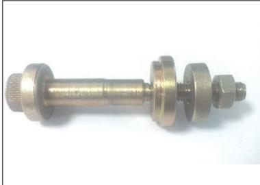
**Herramienta de desensamble del clutch**
