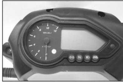
El velocímetro tiene un ancho display digital con una contraluz naranja que permite visualizar los datos perfectamente incluso al manejar de noche.
