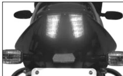
• **Luz de cola o Stop** : La iluminación de la luz de cola y el Stop se llevan a cabo por medio de dos columnas de LEDs. Estos LEDs son de alta intensidad y consumen muy baja energía. Por ejemplo, un LED consume 3 vatios mientras que un bombillo convencional consumiría 21 vatios. Cuando usted opera el freno, se acciona la alta intensidad del LED e incrementa su brillo.
