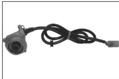
• **Sensor sin contacto mecánico** : En la consola de instrumentos digital no existe ningún dispositivo para medir movimientos mecánicos. El funcionamiento se basa en sensores magnéticos. El sensor magnético es un suiche electrónico que opera por medio de campos magnéticos. El sensor tiene 3 cables, tierra y salidas para enviar la señal cada vez que la rueda gira y pasa por el sensor. La señal es enviada al velocímetro por medio de un cable y marca la velocidad en Km/h.
