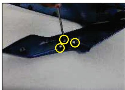
Retire los tornillos del soporte del carenaje (3) con sus arandelas metálicas con un destornillador de estrella y saque el soporte del carenaje.
