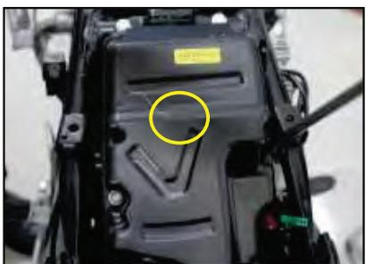
Retire los pernos (4) de la cubierta del filtro de aire con llave de 10 mm.
