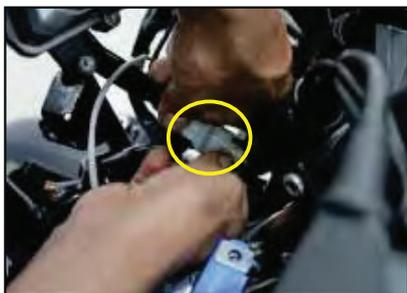
Retire el acople del sensor de velocidad cable (blanco) y los de las direccionales cable (gris y verde).
