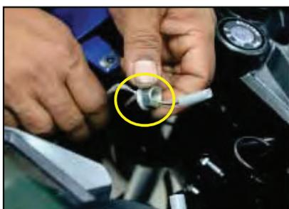
◀ Retire la tuerca 14 mm de los cables de la direccional.
