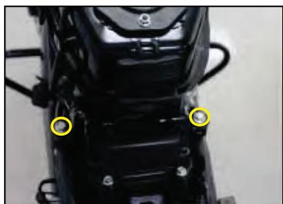
Retire los pernos del ensamble del tanque (3) con llave de 12 mm.
