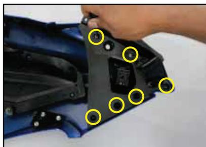
Retire los tornillos del ensamble de la aleta negra del carenaje (3) con sus arandelas con un destornillador de estrella y saque la aleta negra con su soporte.
