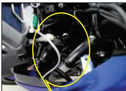
◀ Asegúrese que el cable de.l sensor de velocidad esté enrutado como se muestra en la fotografía y que su pasacables este ajustado a la pinza provista debajo del soporte.
