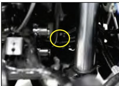
◀ Asegúrese que el ramal eléctrico esté guiado hacia el lado de la tapa del radiador y el lado izquierdo este fijo con la abrazadera y también quede fijo a la abrazadera del tanque.
