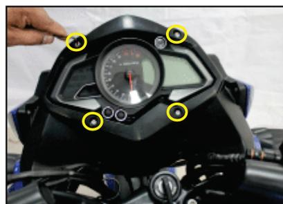
◀ Retire los tornillos (4) de montaje de la cubierta junto con las arandelas metálicas con una llave allen de 3 mm.
