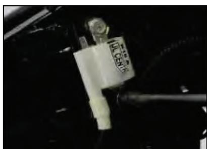
Con una llave T 10 mm retire los dos tornillos de la bobina y proceda a removerla.
