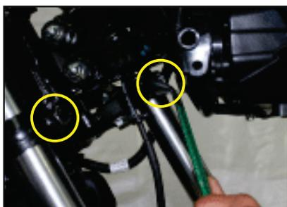
Afloje los soportes del ensamble con llave 17 mm.
