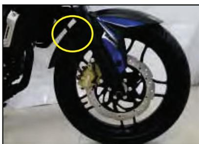
◀ Asegúrese que el pasacables esta ajustado a la pinza provista en la defensa delantera y conectado al acoplador.
