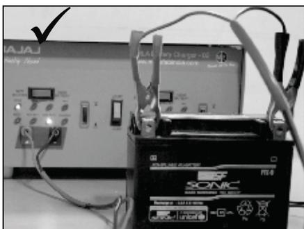
Conecte el cargador de batería VRLA a las terminales de la batería, observando correctamente las polaridades.
