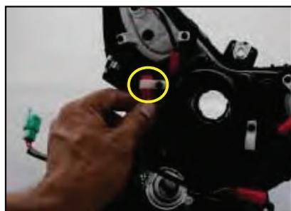
Retire el cableado de la farola de las pinzas como se muestra en la fotografía.
