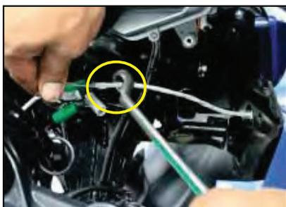
◀ Inserte una llave de 14 mm entre los cables la direccional y retire la tuerca el indicador.
