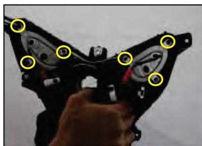
Retire los tornillos de las luces de parqueo (3 cada lado) con destornillador de estrella.
