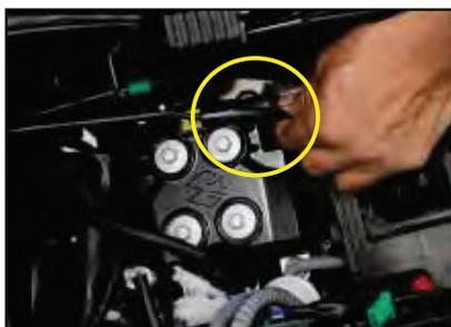
Retire el elemento de filtrado. Retire el cable del acelerador y el cable de la cubierta del cilindro para retirar más fácil la culata.
