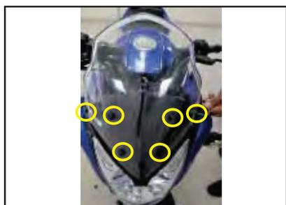
◀ Retire los pernos (6) del cortavientos con sus arandelas con llave heragonal de 4 mm.
