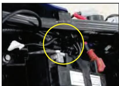
segúrese que el ramal eléctrico esté fijado en cerca de la caja de fusible y junto al relay de arranque.
