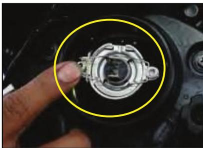
◀ Retire los clips de seguridad (2) presionándolos.
