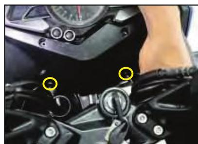
◀ Retire los tapones de presión. Presione el tapón con destornillador. Retire el tapón.
