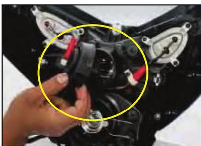
◀ Retire el protector de caucho de la combilla de luz alta y sus conectores.
