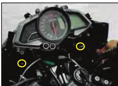
◀ Retire los 3 tornillos de montaje de la farola empleando una llave 8 mm.
