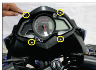
◀ Retire los tornillos (4) de montaje de la cubierta junto con las arandelas metálicas con una llave allen de 3 mm.
