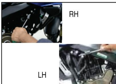
Retire las bujías utilizando la herramienta especial.
