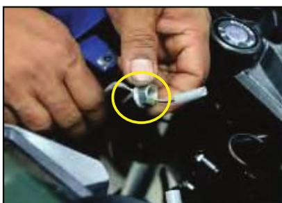
◀ Retire la tuerca 14 mm de los cables de la direccional.
