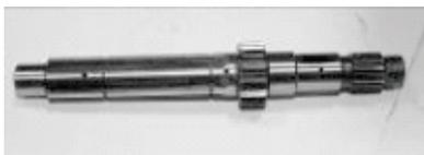
Eje de salida (engranaje de rotación)
