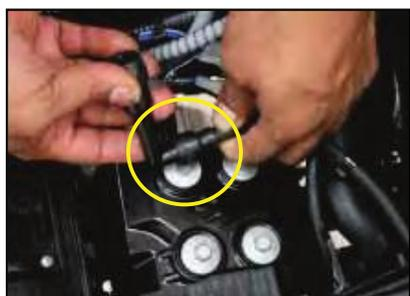
Retire el capuchón de la bujía del cable de la bobina y retire del cable de la pinza.
