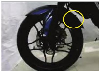
◀ Asegúrese que el cable del sensor este a travez de la pinza provista en la defensa delantera y este conectada al sensor de la llanta.
