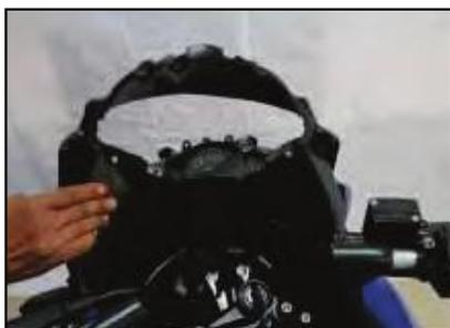
◀ Retire el flap del velocímetro- asegúrese que los 6 cauchos antivibrantes del visor estén en buen estado.
