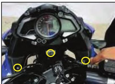
◀ Remueva los tornillos de la cubierta velocímetro como se muestra- 3 tornillos con arandela empleando llave Allen 4mm- 2 tornillos con arandela empleando llave Allen 3mm.
