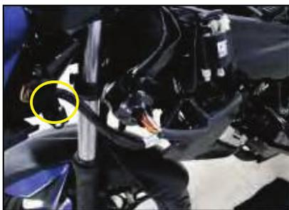
◀ Enrute el ramal eléctrico como en la foto y asegúrese que esté fijado en al chasis con dos abrazaderas plásticas.
