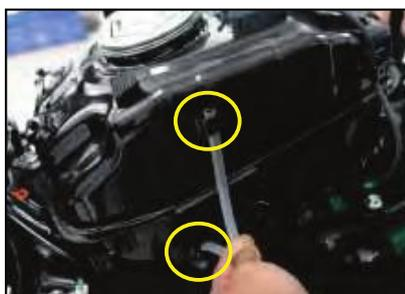
Retire el seguro del tubo respirador y saque el tubo respirador de los soportes provistos en el tanque. Asegúrese que el grifo del combustible esté en OFF.
