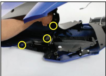
Retire los tornillos del montaje del carenaje lateral (3 cada uno) con sus arandelas ubicados en la cubierta del tanque con destornillador de estrella.
