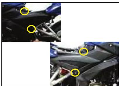
Retirar los tornillos del montaje lateral LH y RH(2 cada uno) con destornillador de estrella.
