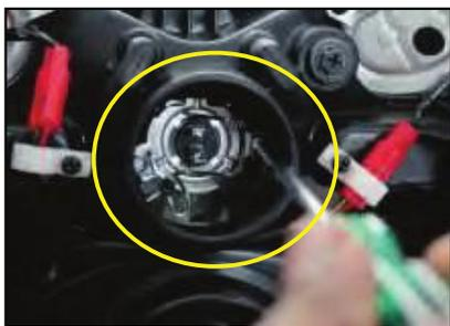
Para un fácil acceso, afloje los tornillos del montaje de la bombilla con destornillador de estrella.
