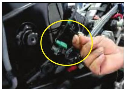
Retire las pinzas y saque los conectores del grifo de combustible.
