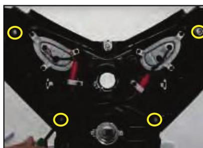
Retire los 4 tornillos del ensamble de la farola con sus arandelas con un destornillador de estrella y llave de 10 mm.
