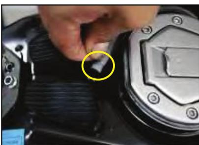
Retire el seguro del tubo respirador y saque el tubo.
