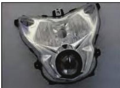
◀ El ensamble de la farola sin bombillas y luces de parqueo, puede ser reemplazado con uno nuevo y reajustar todas las partes removibles.
