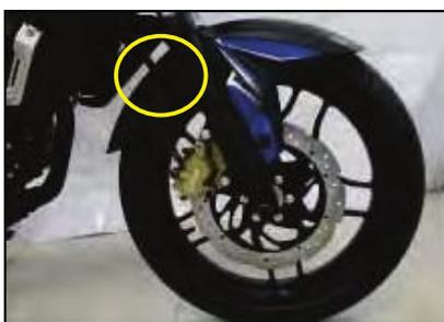
◀ Asegúrese que el pasacables esta ajustado a la pinza provista en la defensa delantera y conectado al acoplador.
