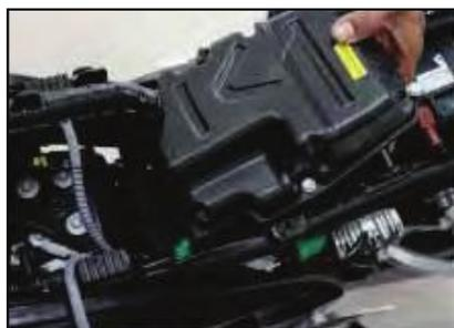
Retire la cubierta del filtro con el filtro de aire.
