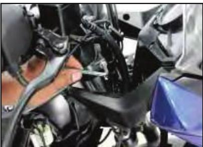
Retire los dos tornillos superiores de la horquilla con una llave Allen 6 mm.
