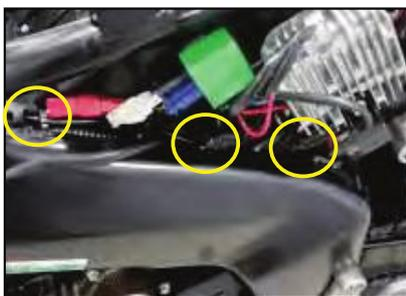
◀ Asegúrese que el ramal eléctrico este fijado al chasis con tres abrazaderas plásticas.
