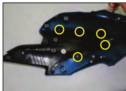
Retire los tornillos de la aleta negra (5) con sus arandelas metálicas con destornillador de estrella y saque la aleta.
