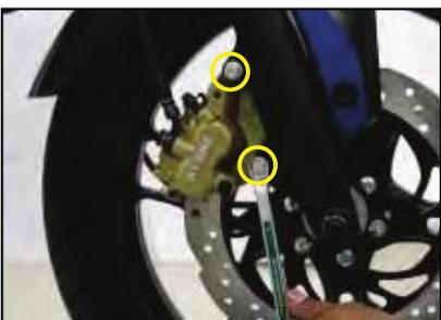
Retire los 2 tornillos de fijación del caliper con una llave 12mm y retírelo.
