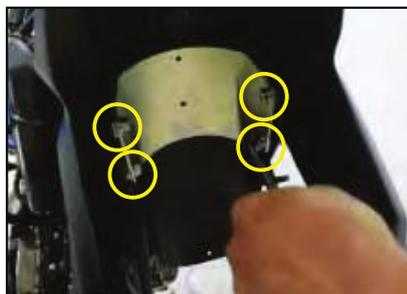
Retire los pernos (4) del protector con llave 12 mm y los pernos (2) con llave hexagonal de 5 mm. Retire el protector.
