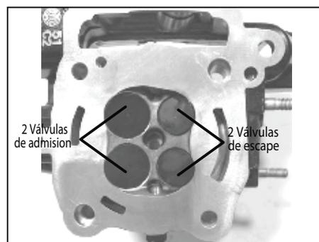
Este motor tiene 2 válvulas de admisión y 2 de escape en comparación con 1 válvula de admisión y 1 de escape de un motor de 2 válvulas. Estas válvulas son más pequeñas y ligeras en comparación con las del motor de 2 válvulas.
