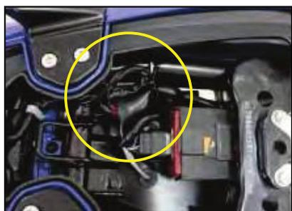
Asegúrese que el cableado eléctrico esté dentro del capuchón y guiado por la abrazadera metálica. Guíe el ramal como se muestra en las imágenes y garantice que esté ajustada al chasis.
