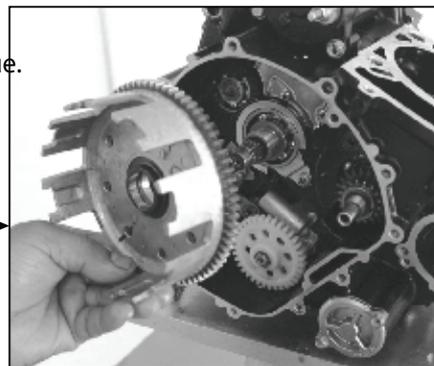
**Consejo:** La tuerca del embrague debe ser retirada girando en la dirección de las agujas del reloj.
