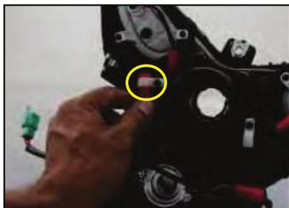
Retire el cableado de la farola de las pinzas como se muestra en la fotografía.
