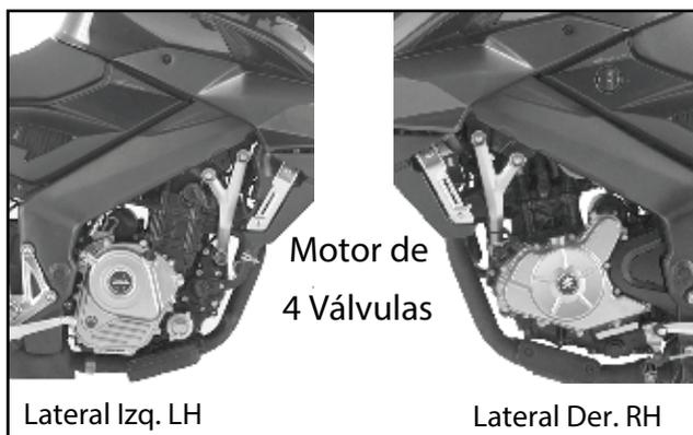
Pulsar 200 incorpora el triple de chispa y motor de 4 válvulas diseñado para un mejor rendimiento que su equivalente, el motor de 2 válvulas de capacidad.
