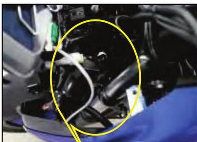
◀ Asegúrese que el cable de.l sensor de velocidad esté enrutado como se muestra en la fotografía y que su pasacables este ajustado a la pinza provista debajo del soporte.
