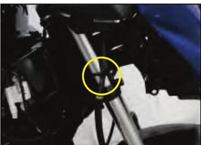
Corte la abrazadera de la manguera del freno.
