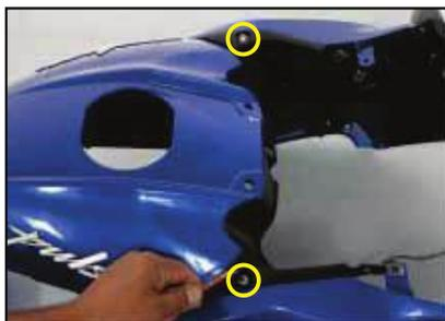
Retire la cubierta del tanque.
