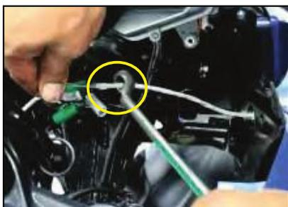
◀ Inserte una llave de 14 mm entre los cables la direccional y retire la tuerca el indicador.
