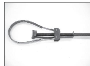
Sujetador del Rotor
