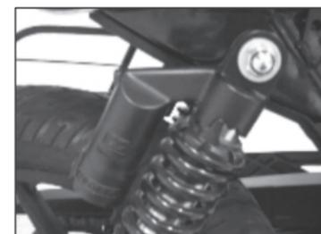
Si los anillos de los amortiguadores en ambos lados no esta ajustados en la misma posición, podria resultar un manejo inseguro.
