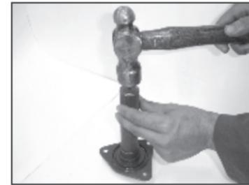
Usar un juego de instalador de rodamientos (P. No. 37 1030 61)
