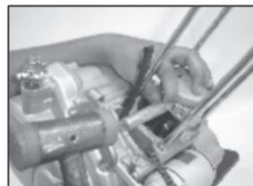
Nota : Colocar un pedazo de paño limpio sobre el area abierta del carter para detener el pin del bulòn del piston si se cae durante la instalaciòn.
