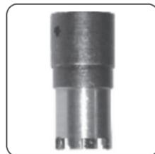
El extractor existente de la tuerca especial puede ser usado para la Pulsar II y Pulsar 200 cc reduciendo el diametro de este a 25.9 +/- 0.1 mm.
