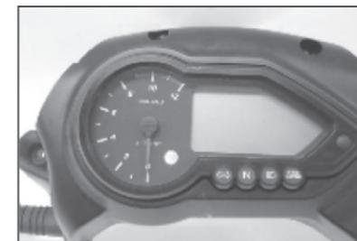
El velocimetro tiene una pantalla LCD amplia con un modo de luz de contraste naranja para una visibilidad superior del instrumento durante las condiciones de conducción nocturna.
