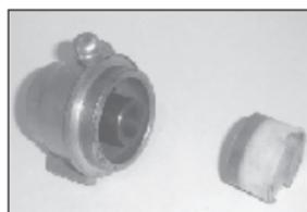
Precaución : No aplicar excesiva grasa o cualquier otro lubricante sobre la cubierta del sensor de la rueda.
