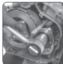
Cuando afloje la tuerca especial para el filtro centrifugo el sujetador del piñon primario debera estar sostenido entre el piñon primario y la carcasa del clutch por el lado superior.
