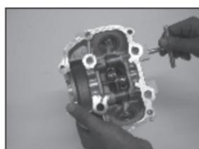
**Nota :** De la misma manera retirar el otro eje de balancines de la tapa valvulas.
