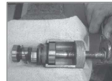
**Extractor del Rodamiento Menor del Eje de Levas**
