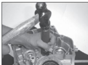
Usar un juego de instalador de rodamientos (P. No. 37 1030 73)
