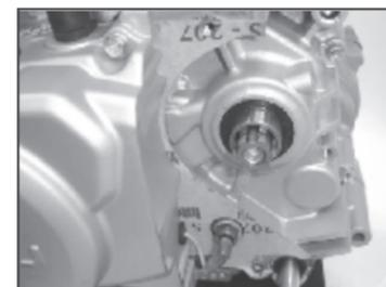
Usando la herramienta especial - Sujetador del sproket de salida - 37 1030 53
