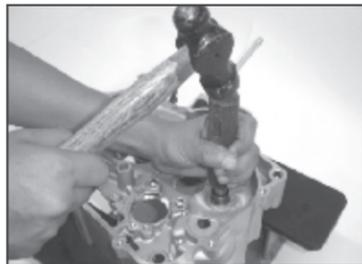
Usar un juego de instalador de rodamientos (P. No. 37 1030 68)
