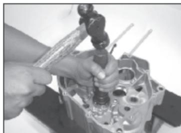
Usar un juego de instalador de rodamientos (P. No. 37 1030 74)
