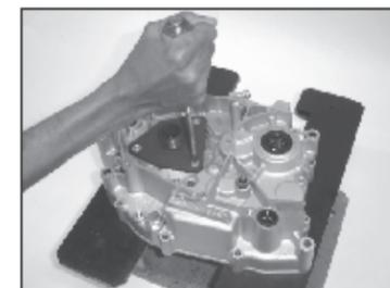
Cubierta del cigueñal LH (Lado del Magneto)
