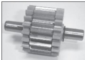
Tensando el piñon auxiliar del balanceador
