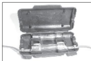
Inspección del Fusible (Capacidad = 10 Amp)
