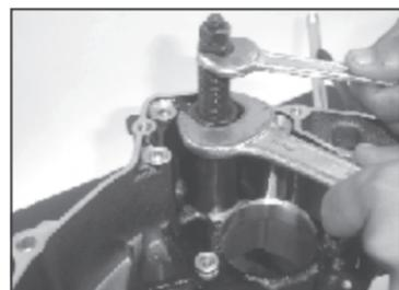
Desmontar el rodamiento de la tapa del piñon auxiliar del conjunto balanceador y la cubierta del cigueñal RH
