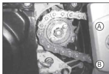
Usando la herramienta Especial : Sujetador del piñon 37 1030 53
