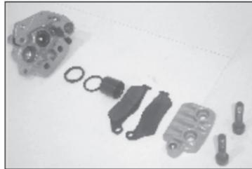
**Advertencia :** No aplicar presión de aire muy alta, esto puede causar que el pistón salte fuera del cilindro. El pistón debe ser sacado gradualmente con presión de aire moderada. Se debe tomar mucho cuidado de no dañar la superficie del sello del agujero de entrada mientras aplica aire a presión.
