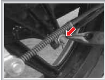
Torque Rod Nut
