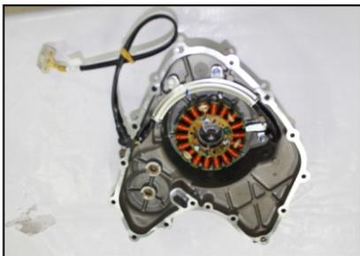
Bobina de carga de batería
