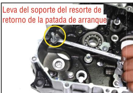
Leva del soporte del resorte de retorno de la patada de arranque
