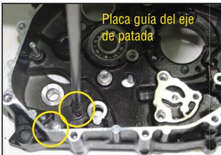
Placa guía del eje de patada
