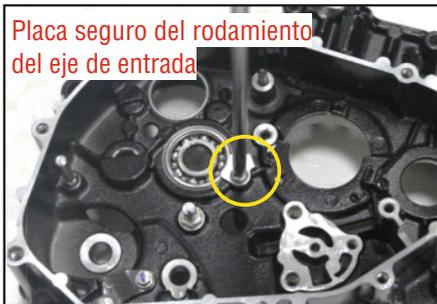
Placa seguro del rodamiento del eje de entrada
