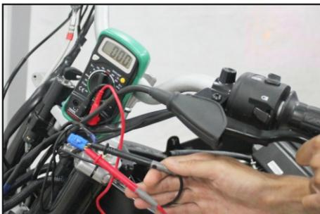
**Equipo de Medición y Prueba:** Multímetro
