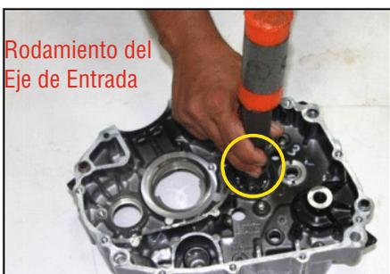
Rodamiento del Eje de Entrada
