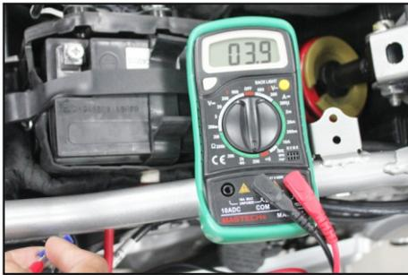
Revisión de la resistencia de la bobina del relé principal
