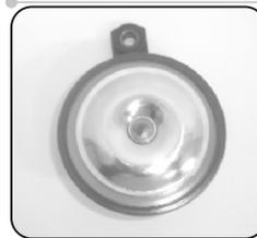
Nunca retire la tapa del resonador ya que puede permitir el ingreso de agua y ocasionar el mal funcionamiento de la bocina.
