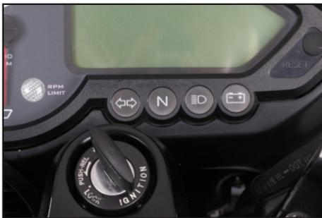
Adicionalmente, se provee de un sistema de indicación de carga de la batería. Al encenderse el icono correspondiente, se indica:
