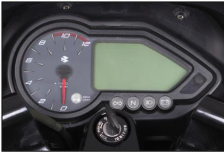
**Consola del Velocímetro** : El velocímetro tiene una amplia pantalla LCD digital con un modo de pantalla retroiluminada de color naranja para una excelente visualización cuando se conduce de noche.
