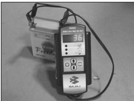
Conecte las pinzas del probador de carga a los terminales de la batería, revisando que las polaridades sean correctas.
