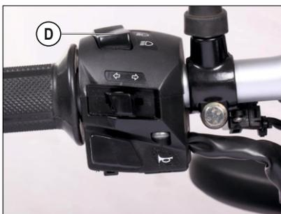
**D. Interruptor de Pase :** Presione el interruptor para encender el filamento de luz alta del faro. Se usa para avisar a los vehículos que vienen en el carril opuesto que se está realizando una maniobra para adelantar a otro vehículo.
