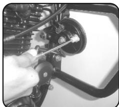
Asegúrese que el resonador no esté presionado por los cables o el ramal ya que distorsionará el sonido.
