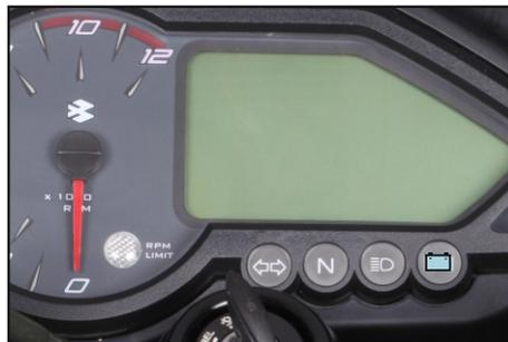
Un modo único de Día-Noche: Los LED se iluminan intensamente durante el día y por la noche la intensidad baja. Esta característica está pensada para la comodidad y seguridad del conductor.
