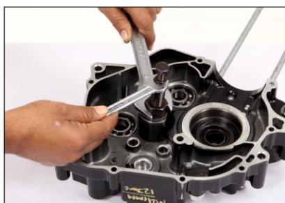
**Usando el extractor del rodamiento del eje de entrada**
