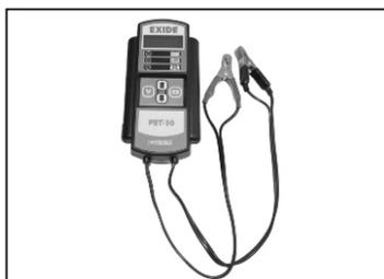
Para revisar la condición de la batería, debe emplearse un probador de carga con las siguientes especificaciones :
