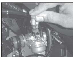
**PRECAUCIÓN:** Si el choke está activado, esto puede incrementar la lectura en 9~10% por lo tanto tener el vehículo caliente es vital para la prueba.
