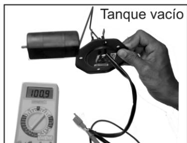
**Medidor del tanque**
