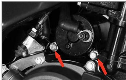
Torque de Ajuste: 1.0 ~ 1.2 kg-m
