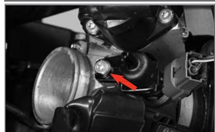
Torque de Ajuste: 0.8 ~ 1.0 kg-m
