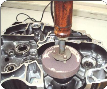
Usando el calentador del motor, caliente el cárter del lado del embrague para encajar suavemente y con facilidad el rodamiento del cigüeñal.
