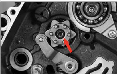
Torque de Ajuste: 1.0 ~ 1.2 kg-m
