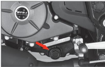
Torque de Ajuste: 0.8 ~ 1.0 kg-m
