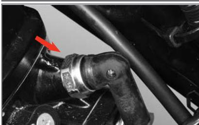
Torque de Ajuste: 1.1 ~ 1.5 kg-m
