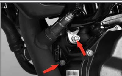
Torque de Ajuste: 2.5 ~ 3.0 kg-m
