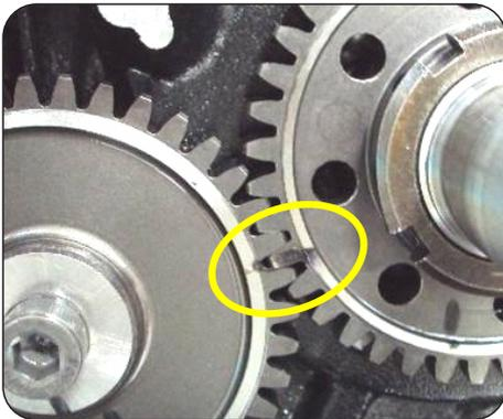
Las marcas de los piñones conductor y conducido del balanceador estén alineadas.
