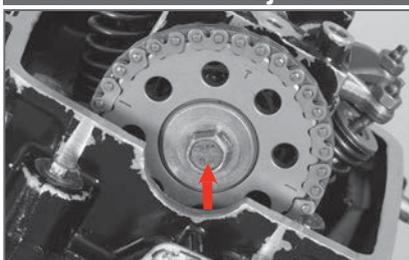
Torque de Ajuste: 2.5 kg-m
