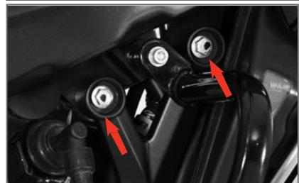
Torque de Ajuste: 2.5 ~ 2.7 kg-m
