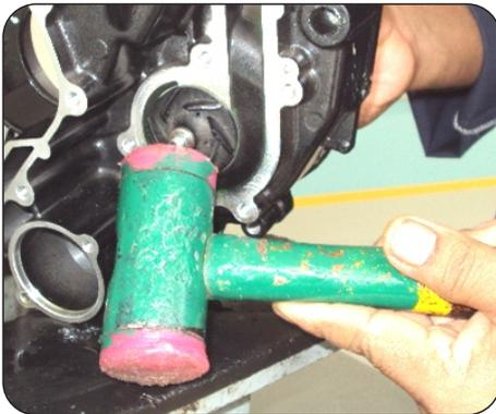
De un golpe al eje del balanceador para retirar el rotor.
