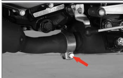
Torque de Ajuste: 1.0 ~ 1.1 kg-m
