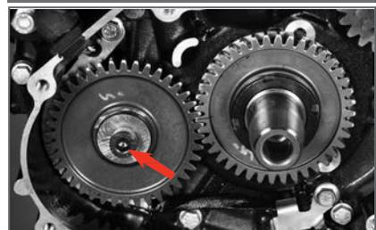
Torque de Ajuste: 2.2 ~ 2.5 kg-m
