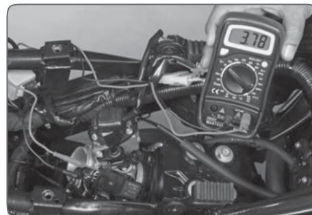
Revisión del Voltaje de Salida
