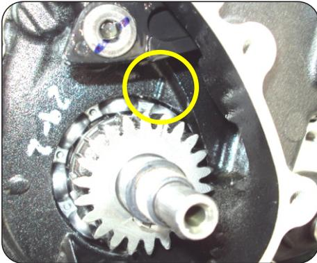
**Cuando alinee las marcas de los piñones conductor y conducido del balanceador siempre asegúrese:**
