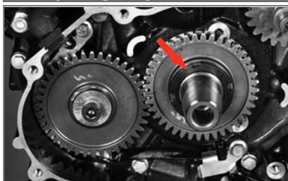
Torque de Ajuste: 5.9 ~ 6.0 kg-m
