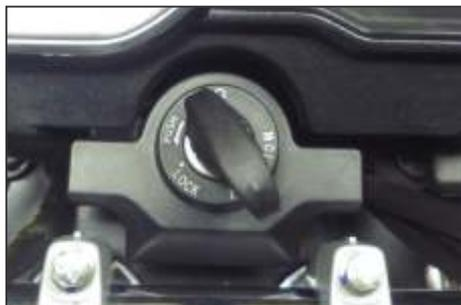
Para bloquear la dirección: Para bloquear la dirección, gire el manillar hacia la izquierda o hacia la derecha. Empuje la llave hacia adentro y gire hacia la posición 'LOCK'. Haga coincidir la posición de bloqueo y gire la llave a la posición de bloqueo. Bloquear la dirección y quitar la llave.
