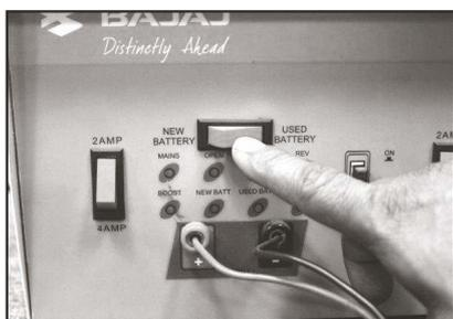
• Seleccione el tipo de batería nueva o usada
