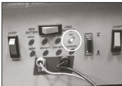
• En caso de conexiones de polaridad incorrecta, el LED rojo "REV" se iluminará en el cargador.
