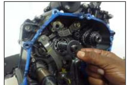
**Desmontaje del conjunto de embrague**
