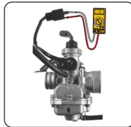
Chequeo de voltaje en condición parcialmente abierto
