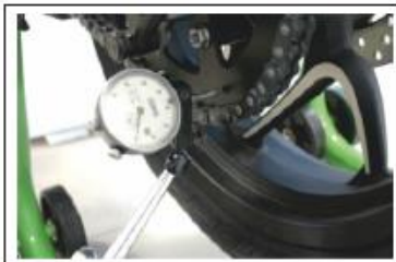
Pandeo de sprocket trasero
