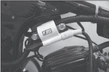
9. Retire las bobinas de alta, derecha e izquierda con una llave 10 mm.
