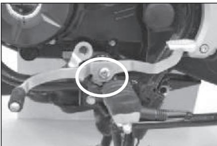
8. Retire la palanca de cambios con un tornillo Allen de 6mm.
