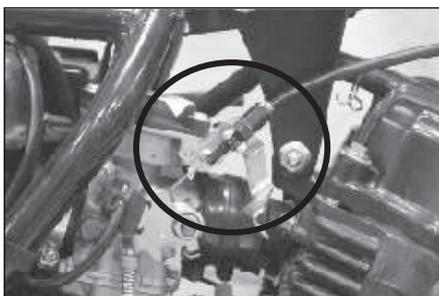
3. Rutee el cable aceleradro desde la parte externa del soporte superior del motor como se muestra en la foto.
