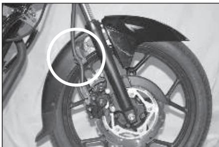
3. Rote la manguera a travez de la abrazadera en la parte derecha del guardabarros delantero y esta sea ensamblada al caliper.
