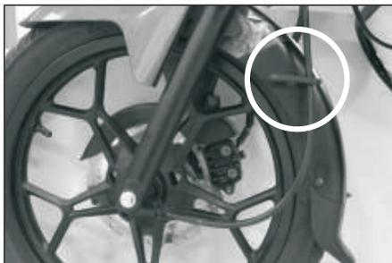
1. Rutee el cable del velocímetro a través de la abrazadera ubicada al lado izquierdo del guardabarros delantero.
