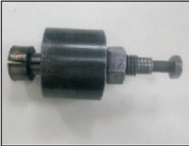
**Remover el buje anti fricción**
