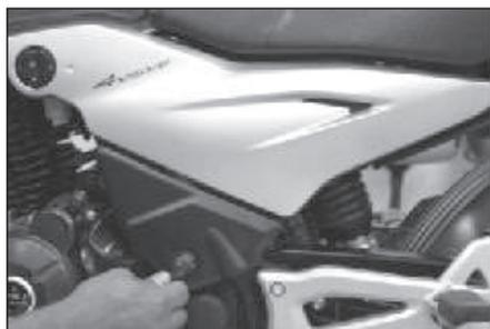
1. Retire la cubierta izquiada con la llave de encendido.
