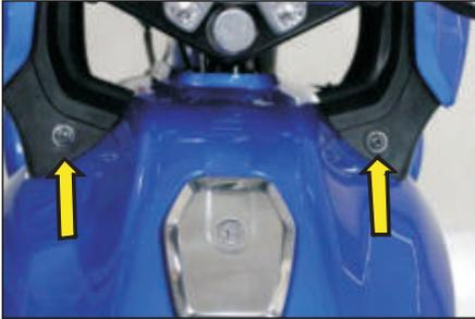
1. Retire la farola junto con el carenaje frontal y su estructura retirando:
