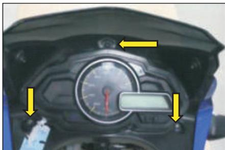
2. Retire los tornillos del velocímetro (3 Unds) con un destornillador de estrella y retire la cubierta.
