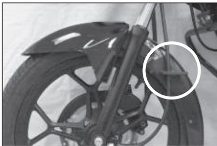
1. Rutee el cable del velocímetro a través de la abrazadera ubicada al lado izquierda del guardabarros delantero.
