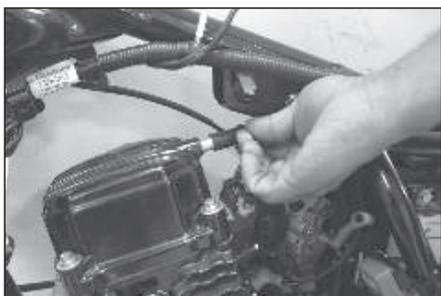
7. Retire el conducto respiradero del motor retirando el clip.
