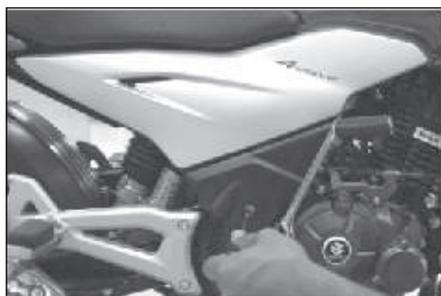
3. Retire el tornillo de estrella de la cubierta derecha y retire la cubierta..
