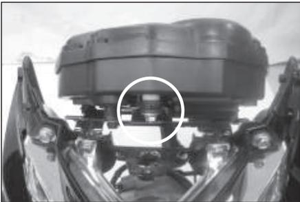
9. Retire los tres tornillos de montaje del velocímetro con una llave 8mm.
