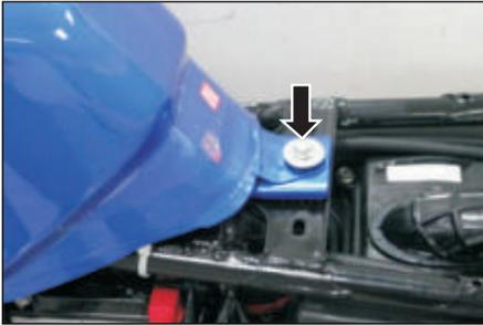
5. Retire el tornillo de fijación del tanque con una llave 10 mm. Retire la conexión del medidor de combustible y retire el tanque.
