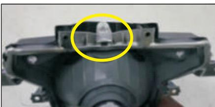
11. Retire el tornillo con un destornillador de estrella y retire el flap.
