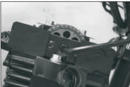
16. Retire el tornillo fijador del piñon, utilizando la herramienta especializada para fijar el piñon. Retire el piñon.
