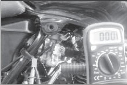
**Chequeo continuidad cuando el magneto este al frente del sensor.**
