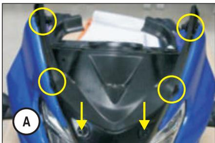
3. Retire los tornillos tipo allen del visor carenaje (6 Unds) con una llave 6mm y retire el visor.
