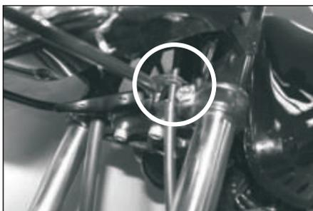
2. Asegure que el caucho del cable medidor de velocidad esta en la abrazadera tipo 'U' y este se encuentre debidamente conectado.
