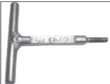
**Removedor del balancín del eje**
