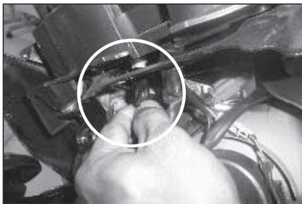
2. Retire el cable del velocímetro, el caucho de la farola y demás conectores. retire la farola.
