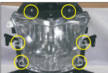
6. Retire los 6 tornillos de fijación de la farola con un destornillador de estrella.
