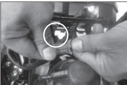
10. Retire la farola acople (verde) direccional izquierda (Verde), direccional derecha (gris) y retire el velocímetro.
