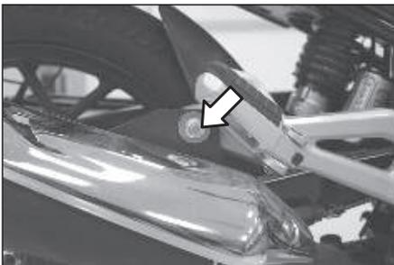
11. Retire el mofle retirando las tuercas de soporte delantera y trasera.
