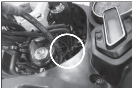
1. Rutee el cable del acelerado a travez de la guia cable.
