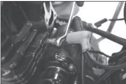
10. Retire las conexiones de sensor de temperatura
