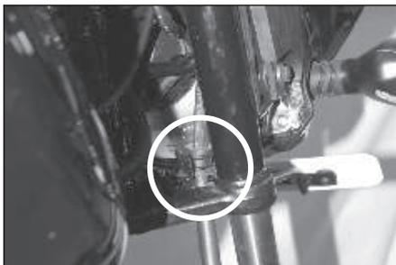
2. Rote la manguera del freno tal como se muestra en la imagen y asegurece que esta esta guiada atravez de la abrazadera en el soporte inferior.
