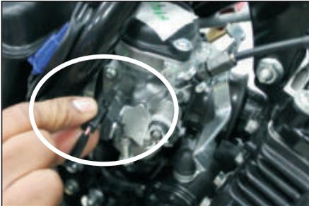
6. Retire el TPS y el cable acelerador del carburador.
