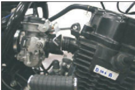
12. ahora el carburador puede ser retirado facilmente junto con el conducto de admisión.
