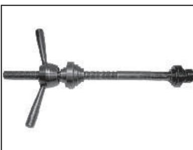
**Instalador de los rodamientos superiores e inferiores de cunas de dirección.**
