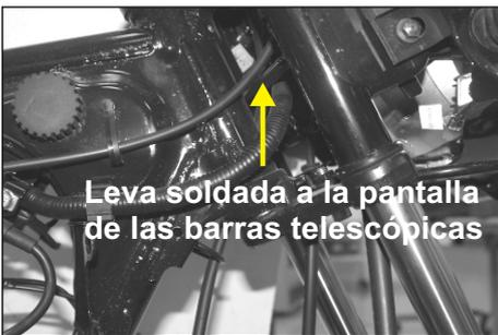
9. Dirija el ramal eléctrico por debajo de la leva soldada a la pantalla de las barras telescópicas.
