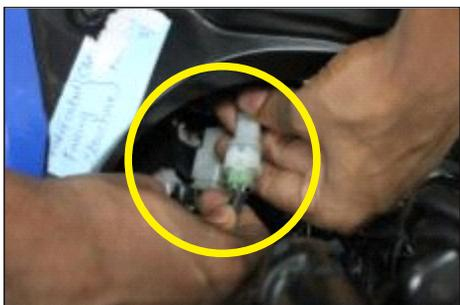
• Suelte el conector del sensor de velocímetro y el conector del faro-velocímetro.
