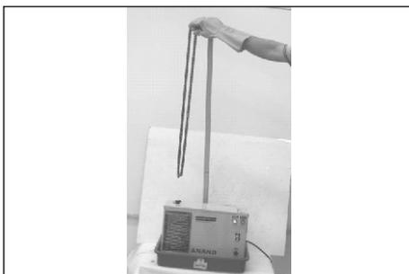
4. Gire el rodillo usando la mano para que la cadena deslice en el rodillo para drenar el exceso de grasa y lubricarla uniformemente.
