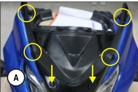
3. Retire los pernos de montaje del parabrisas (6 und) y las tuercas y retire el parabrisas.
