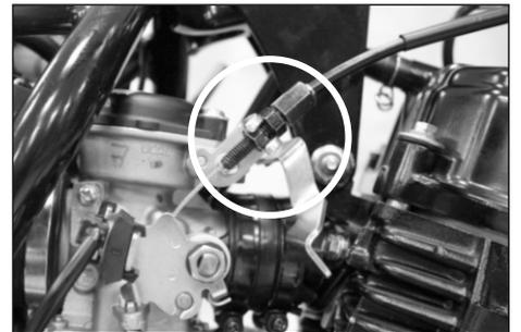
Direccionamiento del Cable de Acelerador 150S
