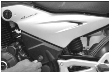
1. Retire la cubierta lateral izquierda con la llave de contacto y saque la cubierta.
