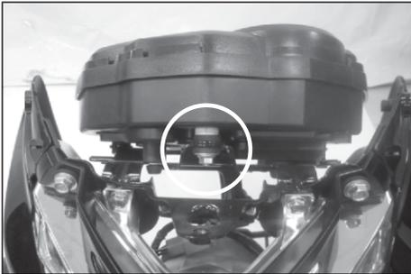
9. Retire los pernos de sujeción del velocímetro (3 und) con una llave hexagonal de 8 mm
