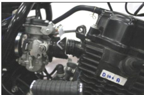
12. Ahora el carburador puede retirarse fácilmente del vehículo junto con el ducto lateral del tubo de admisión.
