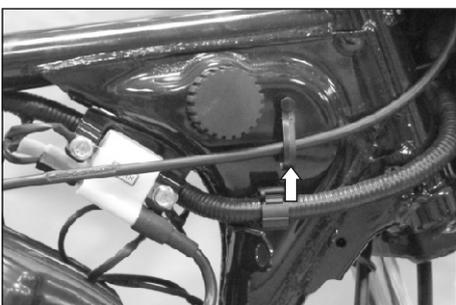
2. Dirija el cable del acelerador por la abrazadera de PVC que se encuentra cerca del jebe de del lado derecho del tanque.
