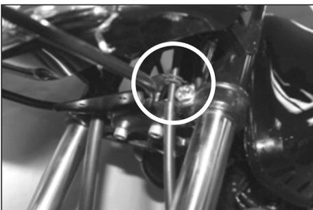
2. Asegúrese que el jebe del cable del velocímetro esté encajado en la abrazadera tipo U que se encuentra debajo del soporte inferior y conecte el velocímetro.
