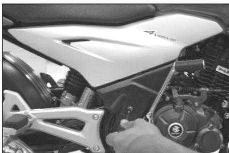
3. Retire el tornillo de sostiene la cubierta lateral derecha con un desarmador y saque la cubierta derecha.
