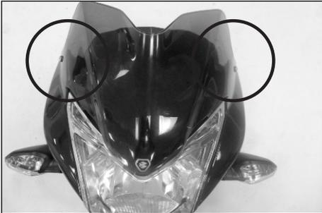
5. Retire los tornillos que sostienen el parabrisas (2 und.) con un desarmador.
