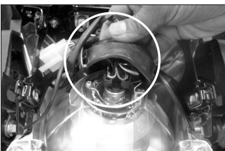
3. Retire la cubierta de jebe y desenchufe la conexión del faro.
