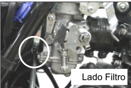
7. Afloje los tornillos de las abrazaderas del carburador con un desarmador.
