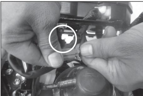
10. Desenchufe las conexiones del faro (verde), direccional izquierdo (verde) y direccional derecho (gris) y retire el velocímetro.
