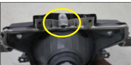
11. Retire el tornillo de montaje de la solapa del faro con un desarmador y retire la solapa.
