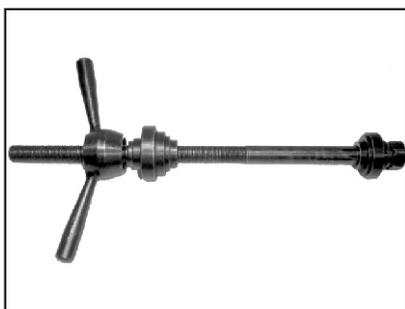
**Instalador de Rodamiento Superior e Inferior del Chasis**
