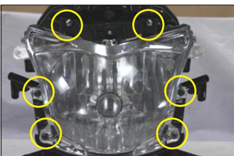
6. Retiro de los 6 pernos de montaje del faro delantero con un desarmador.
