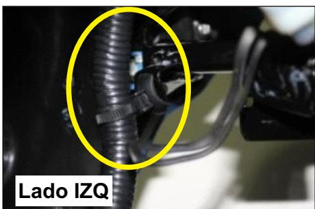
• Retire el clip, del cuerpo del ramal, del agujero de la estructura del faro, en los dos puntos.
