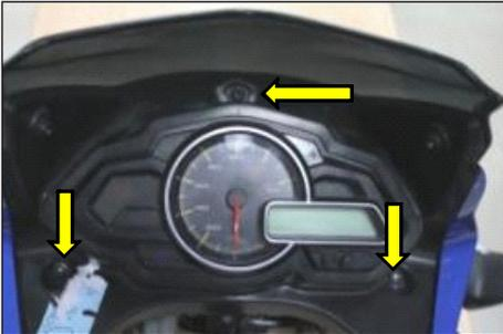
2. Retire los pernos de la solapa del velocímetro (3 und) con un desarmador y retire la solapa.
