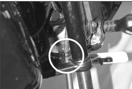
2. Dirija la manguera de freno como se muestra en la foto y asegúrese que la manguera de freno esta dirigida por la abrazadera del soporte inferior.
