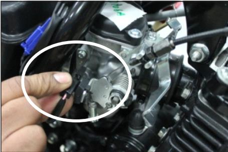
6. Retire el TPS y el cable del acelerador del carburador.
