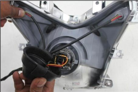
8. Retire la cubierta del foco y el conector.
