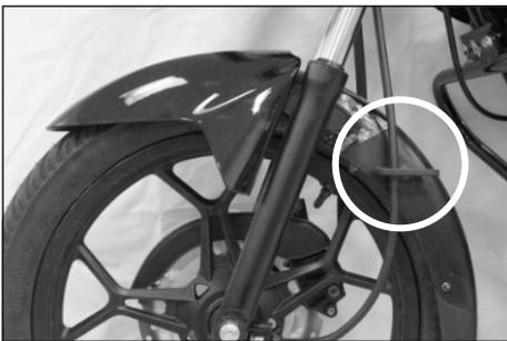
1. Dirija el cable de velocímetro por la abrazadera del lado izquierdo del guardafango delantero.
