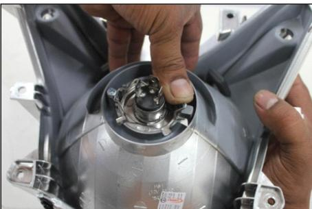
9. Retire el clip del foco presionándolo hacia abajo y retire el foco.
