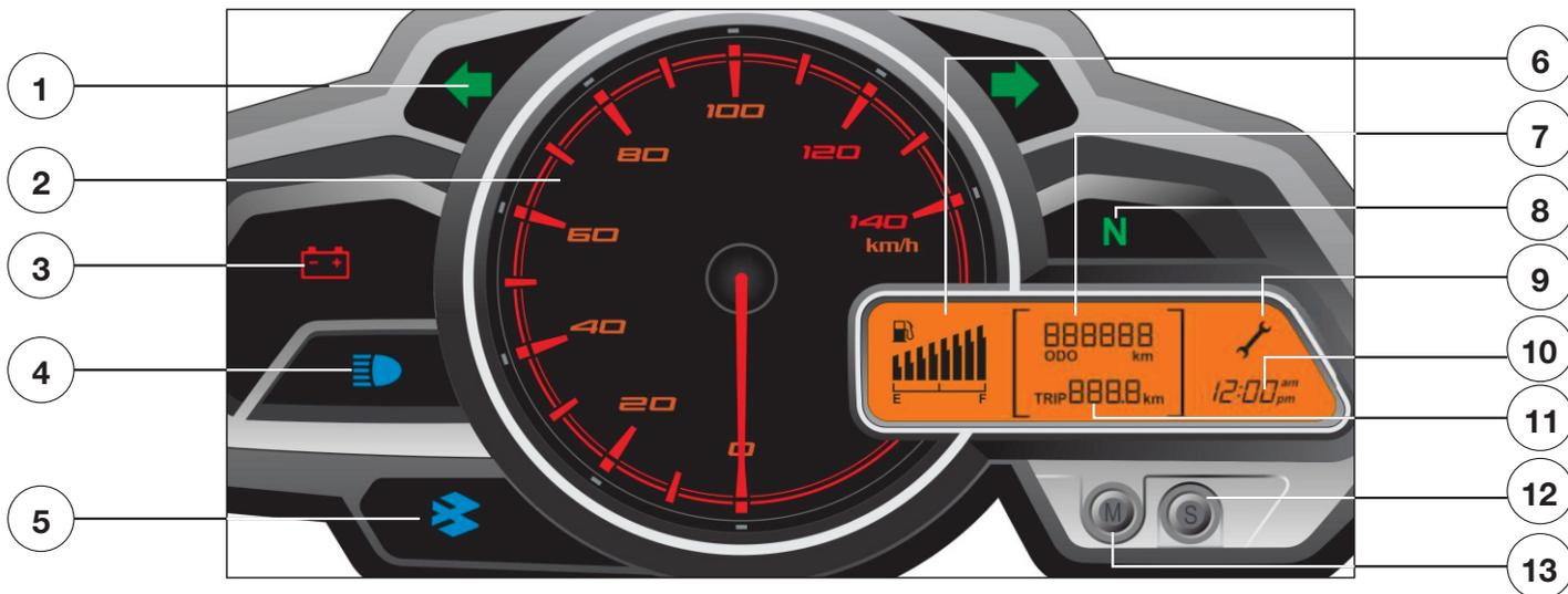
1. **Indicador Direccionales (Izq y Der)** : Cuando el interruptor de direccionales se gira a la izquierda o derecha, el piloto indicador de direccionales izquierdo o derecho se encenderá.
