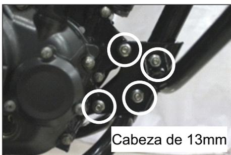
11. Retire el soporte superior del motor, las tuercas y pernos posteriores (superiores e inferiores). También retire la tuerca inferior trasera que soporta el motor de tal forma que el motor pueda moverse hacia adelante.
