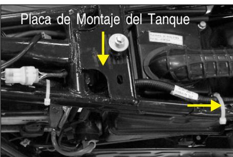
4. Asegúrese que el ramal eléctrico esté atado con una abrazadera al tubo del chasis y dirija el ramal por debajo de la placa de montaje del tanque de combustible.
