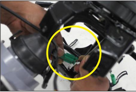
7. Desenchufe el conector del faro delantero y retire el faro.
