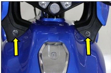
1. Se retira el ensamble del faro delantero completo junto con el faro delantero y la estructura del faro, abriendo:
