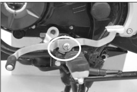
8. Retire el perno Allen que sostiene la palanca de cambios con una llave de 6mm.
