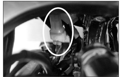
Direccionamiento del Cable de Velocímetro 150S
