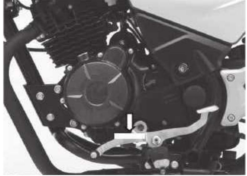
El número de motor está ubicado en la carcasa de motor del lado izquierdo bajo la palanca de cambios.
