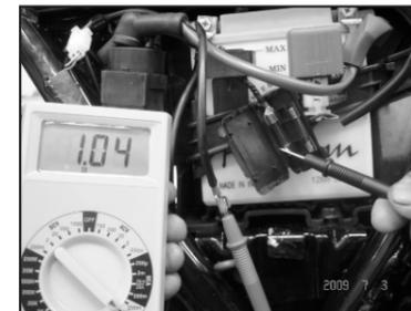
**Corriente de Carga de la Batería CC**
