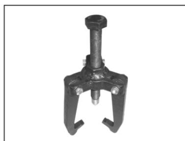
**Extractor del Volante del Magneto (Arranque Eléctrico)**
