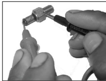
**Sensor de Temperatura del Motor**
