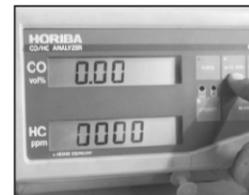
Realice, de acuerdo a la recomendación del fabricante, la revisión inicial para confirmar el correcto estado del equipo (Si la revisión no confirma un correcto estado, entonces realice la calibración de gases de acuerdo a las recomendaciones del fabricante). Ajuste la pantalla del equipo en cero antes de tomar la lectura.
