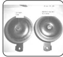
Nunca retire la tapa de resonancia, pues puede permitir la entrada de agua y dañar el funcionamiento.
