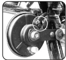
Asegurese del buen estado de los cables del pito.
