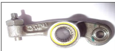
Tenga sumo cuidado cuando retire el balancín y su eje porque el rodamiento del pivote tiene 20 rodillos sueltos colocadas en la jaula exterior. Mientras lo retire, los rodillos no deben caer al interior del motor.
