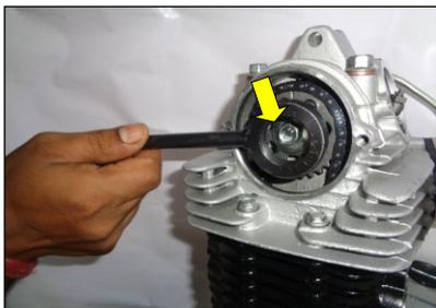
Use la herramienta especial con código EC 10 1200, Sujetador del Piñón del eje de levas, para aflojar o ajustar el perno del piñón del eje de levas
