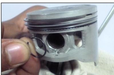
Mientras retira o coloca el seguro del bulón del pistón, cubra el borde del cárter con un trapo de algodón limpio y libre de pelusa para evitar que el seguro caiga dentro del motor, y por consiguiente evitar abrir innecesariamente el motor.
