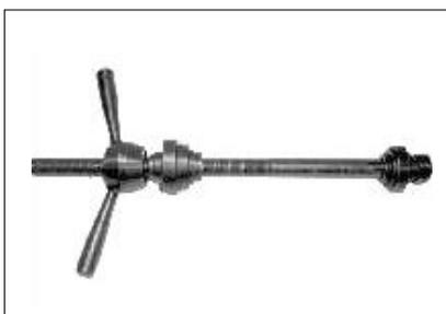
**Instalador de Rodamiento Superior e Inferior del Chasis****Código** : 37 1801 06**Aplicación:** Para instalar las pistas superior e inferior en su asiento en el chasis.
