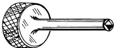
Es usado para manipular el tornillo de la válvula de ajuste con su cabeza cuadrada.
