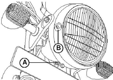
**9)** Para deslizar correctamente la luz baja, existe un tornillo ("A") debajo de la lámpara delantera o farola. Apriete el tornillo para deslizar la trayectoria de la luz hacia arriba o suéltelo para deslizarla hacia abajo.
