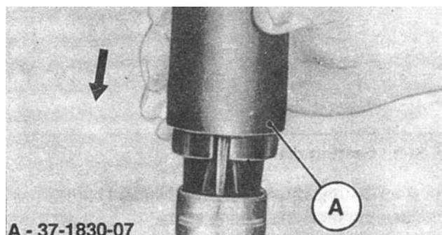
Entre la botella y la barra del amortiguador va montado un retenedor de aceite dentro del cual desliza la barra. Esta herramienta sirve para instalar este retenedor.
