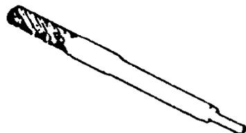
Es una herramienta usada para remover o montar las guías dentro de la culata.
