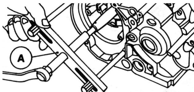
Se usa para separar las carcazas de las motos o para remover el cigüeñal.
