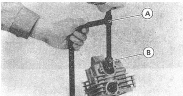
Mientras se desmontan y montan las válvulas de la culata. La foto muestra el uso de la herramienta. La parte inferior está localizada sobre la cabeza de la válvula mientras el otro con el adaptador está localizado contra el retenedor del resorte. Cuando se gira en sentido horario, el resorte se comprime al tiempo que las cuñas quedan libres y facilitan el desmontaje de las válvulas.
