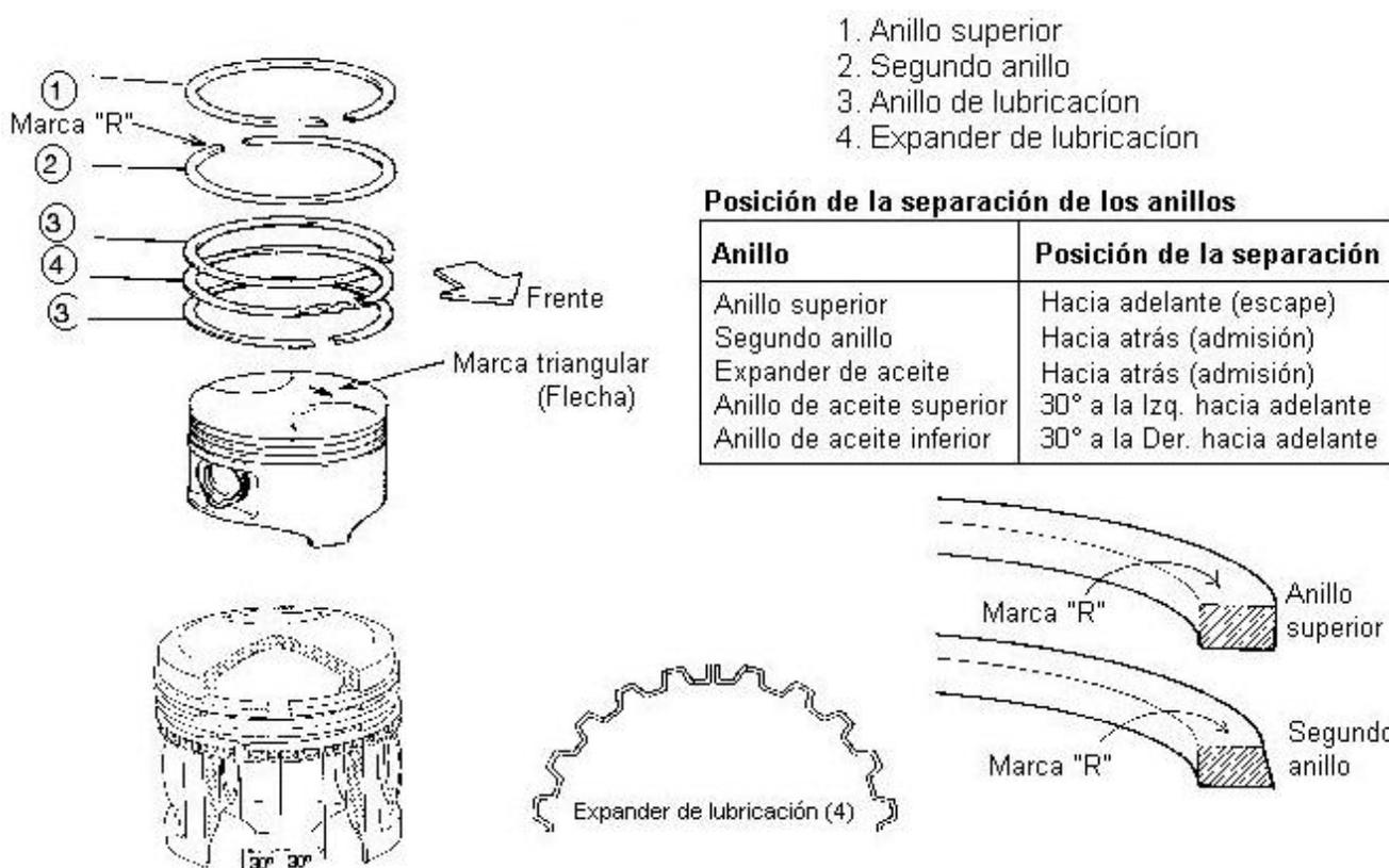
Los anillos del motor de la BOXER deben montarse en las ranuras específicas y con la posición adecuada según lo indica la marca en la cabeza del pistón, la cual señala hacia el escape.
