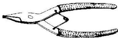
Es usada para remover y fijar los pines circulares montados en diámetros exteriores.
