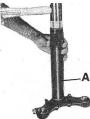
Se utiliza para empujar la pista del rodamiento de la columna de la dirección.
