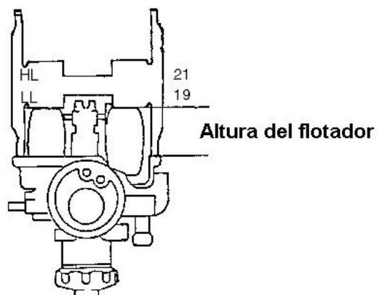
La altura del flotador para el carburador de la BOXER es  $20 \pm 1$  mm. Esta galga de altura puede ser usada con sus niveles de altura máxima HL = 21 mm y nivel mínimo LL = 19 mm.
