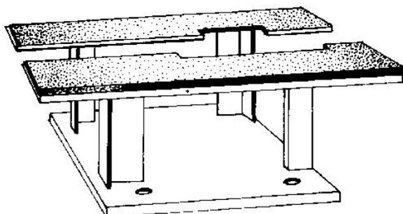
Este es un soporte metálico con caucho en la plataforma superior y sirve para mantener el motor completo y las carcasas en mitades mientras arma o desarma el motor.
