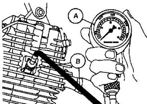
Uno de los extremos del adaptador de la manguera es conectado al manómetro y el otro es fijado a la culata donde se atornilla la bujía.
