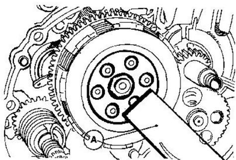
La herramienta se fija sobre las seis proyecciones de la volante del embrague referencia # 31-10-1135, para aflojar o apretar la tuerca del embrague.
