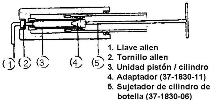
Los adaptadores (37-1830-11) pueden usarse con el sujetador (37-1830-06) para manipular el conjunto del cilindro y del pistón cuando se desarma el amortiguador delantero, al remover el tornillo "allen" localizado en el extremo inferior.
