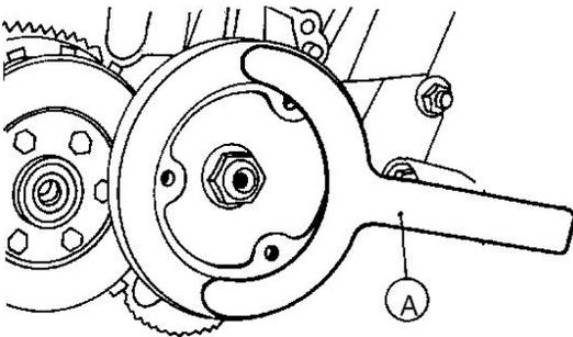
El filtro centrifugo esta montado en el eje del cigüeñal al lado del embrague. Tanto para aflojar como para apretar esta tuerca es necesario fijar el filtro de aceite.
