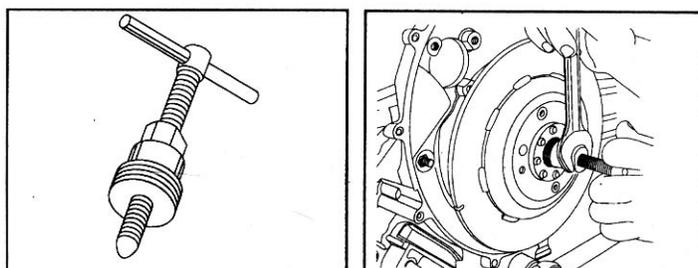
Esta herramienta se utiliza para retirar la volante después de desmontar la tuerca sujetadora. El extractor se coloca sobre la volante, la cual tiene rosca izquierda y a medida que enrosque el tornillo central, el extractor ira extrayendo la volante.
