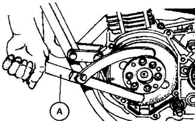
Es una herramienta usada para manipular la volante mientras se monta o se desmonta.
