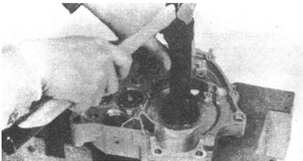
Es un conjunto de empujadores de diferentes tamaños según sea el tamaño del rodamiento. Dentro de este conjunto de empujadores hay dos tipos: un empujador interno y otro externo. El empujador externo es usado para remover los rodamientos de los asientos.
