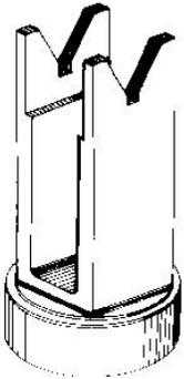
Esta herramienta se utiliza para chequear el balanceo y alineación del cigüeñal. El cigüeñal, con sus dos rodamientos, puede ser montado en los cortes en "V" de la herramienta y mientras lo gira puede verificar su estado con la ayuda de un comparador de carátula.
