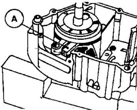
Mientras se monta el cigüeñal en la carcaza con la ayuda de una prensa, las contrapesas del cigüeñal se pueden desalinear debido a la fuerza de la prensa. Esta deformación del cigüeñal ocasionara fallas en su trabajo en la carcaza. Para evitar la deformación, se debe colocar una cuña entre las dos contrapesas del cigüeñal al empujarlo dentro de la carcaza. La cuña asegura la tolerancia entre las contrapesas y evita que se desalineen.
