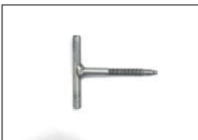
Extractor del eje del balancín
