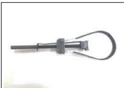
Sujetador del rotor de la volante
