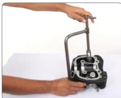
**Adaptador y Compresor del Resorte de Válvulas**
