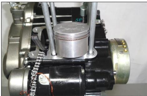
Usando el empujador del bulón de pistón - 74 9309 89
