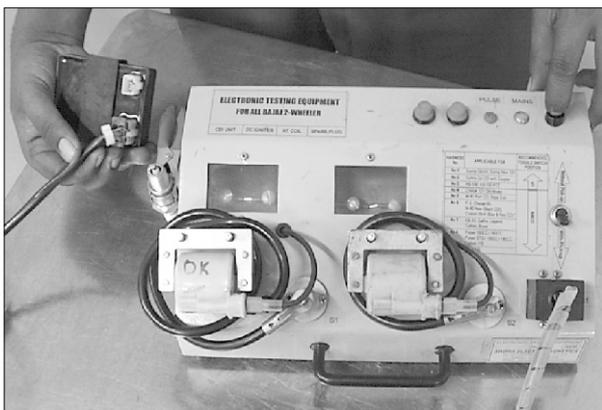
La bobina de alta y el CDI pueden revisarse en el probador electrónico
