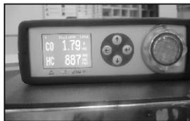
Realice, de acuerdo a la recomendación del fabricante, la revisión inicial para confirmar el correcto estado del equipo (Si la revisión no confirma un correcto estado, entonces realice la calibración de gases de acuerdo a las recomendaciones del fabricante). Ajuste la pantalla del equipo en cero antes de tomar la lectura.
