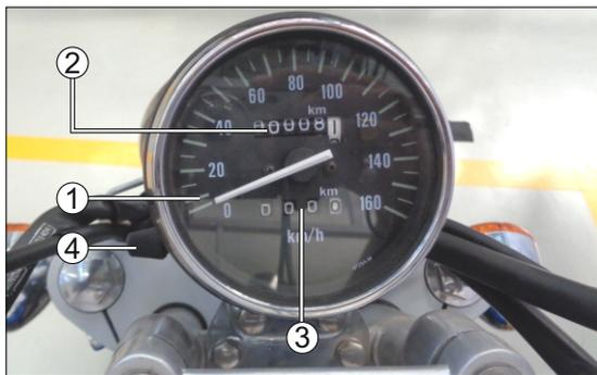
1. **Velocímetro** : La aguja del velocímetro muestra la velocidad del vehículo en km/h.
