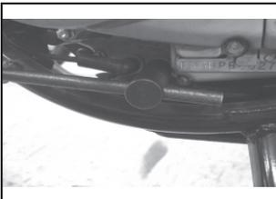
Control del torque del tapón de drenaje al abrir y al cerrar.
