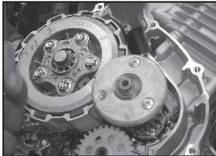
Usando la herramienta especial: Sujetador de piñón primario 37 10DJ 28
