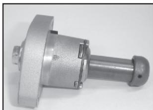
**Ensamble del tensionador de cadena:**
