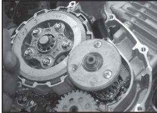
Usando la herramienta especial: Sujetador de piñón primario - 37 10DJ 28 Usando la herramienta especial: Copa torre (Castillo)
