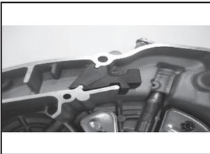
Confirmación del caucho en el pasaje de desfogue en la cubierta derecha.
