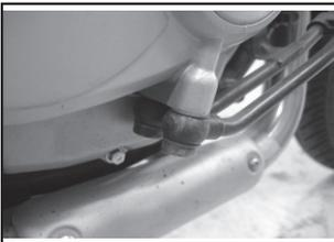
Confirmación de que no haya fugas por las tuberías de aceite (inspección visual)
