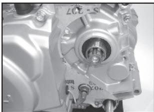
Usando la herramienta especial - Sujetador del piñón de salida - 37 1030 53
