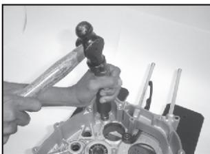
Usando el kit de instalación de rodamientos (P. No.: 37 1030 61)
