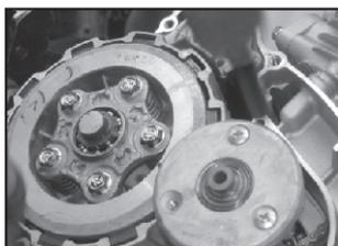
Usando la herramienta especial - sujetador de piñón primario: 37 10DJ 28 y usando la herramienta especial - copa torre (Castillo) 37 10DJ 43
