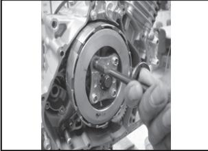
Apriete uniformemente los tornillos de soporte del clutch (diagonalmente) .
