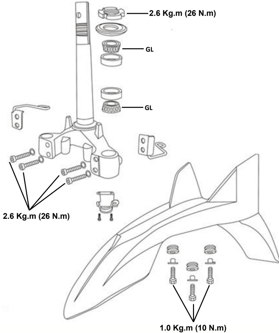
Remueva las tuercas de la horquilla con la ayuda de la herramienta especial, afloje primero la tuerca superior, si es necesario utilice dos llaves, una para sujetar la tuerca inferior y la otra para aflojar la tuerca superior. Fig.5.70
