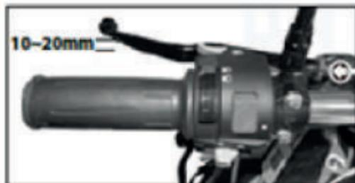
**8.** Encender el motor para verificar que la palanca del embrague funcione correctamente.
