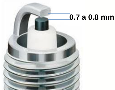
Abertura de electrodos 0.7 a 0.8 mm.
