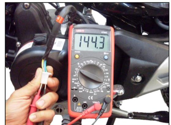
Terminal (+) del multímetro → Terminal de entrada de la bobina de alta
