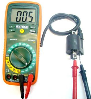
Terminal (+) del multímetro → Terminal de entrada de la bobina de alta
