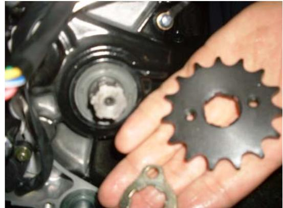
Cuando se instale la rueda dentada trasera es esencial apretar los tornillos de sujeción del sprocket con el torque especificado y en forma de X
