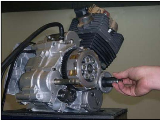
Utilizando el sostenedor de volante, restrinja el movimiento de esta y proceda a desapretar la tuerca con la herramienta adecuada.
