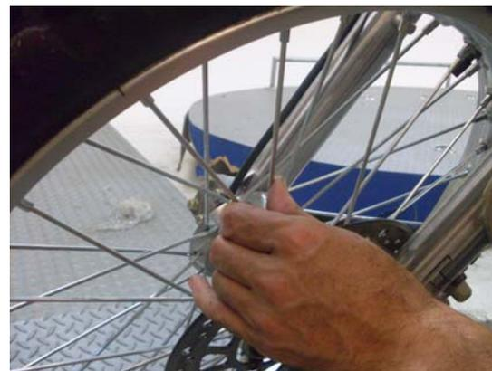
Luego de que garantice la tensión de los radios, verifique la alineación de los aros de las ruedas.
