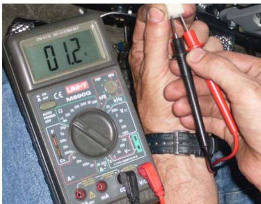
**Voltímetro**, se mide voltaje en el sistema eléctrico de la motocicleta en corriente alterna y corriente
