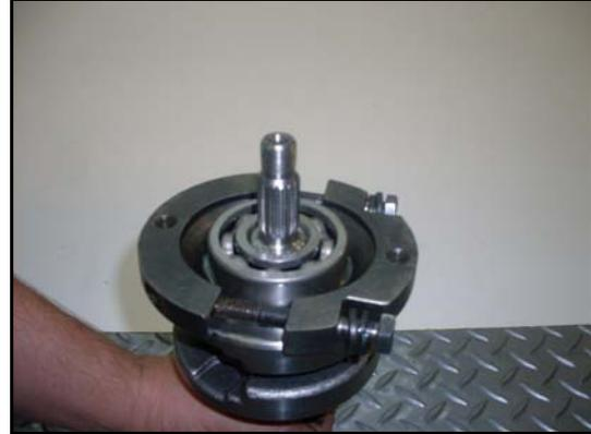
Apriete los tornillos hasta que la balinera se ajuste a la cavidad del extractor.
