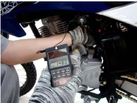
Observe las Rpm medidas en el tacómetro digital, modifíquela si es necesario.
