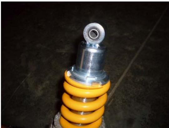
Para la modificación de la tensión del resorte, utilice una llave de gancho, gire con ella el mango de ajuste hasta la posición deseada.
