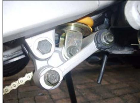
Desatornille las tuercas de los pernos que sujetan el amortiguador al chasis y al brazo inferior de la suspensión.
