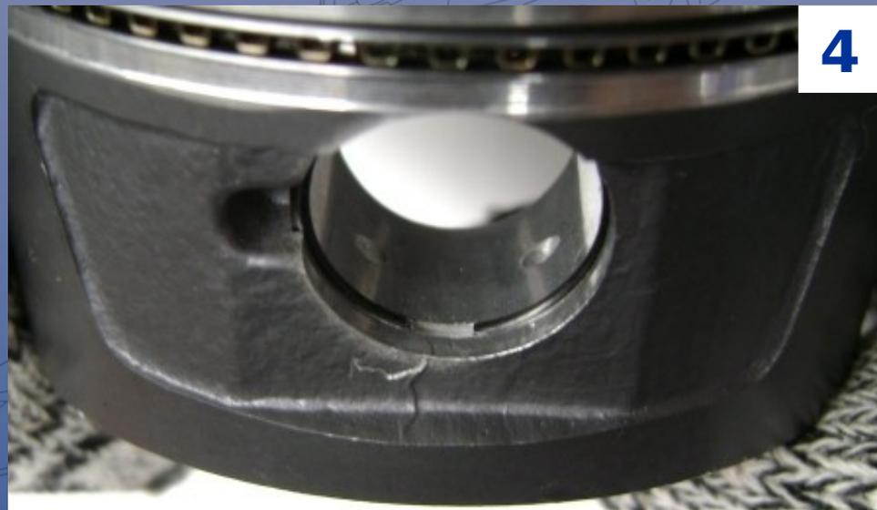
Inserte el pasador para sujetar el pistón a la biela.
