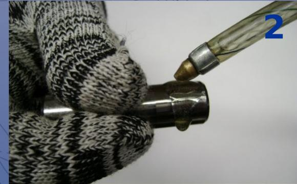
Instale un **nuevo** pin circular en uno de los lados del pistón, insertando una de sus puntas en la ranura y luego presionándolo hasta que se asiente en toda su superficie.
