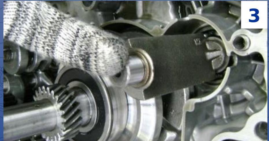
Posicione el contra balanceador en el rodamiento que se encuentra en la parte posterior del motor, asegurándose de que quede asentado completamente y que la cuña quede sobre el costado derecho del motor (clutch, piñón primario).
